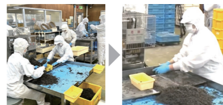
設備の設置角度変更により作業員が6名→4名になり生産性UP
