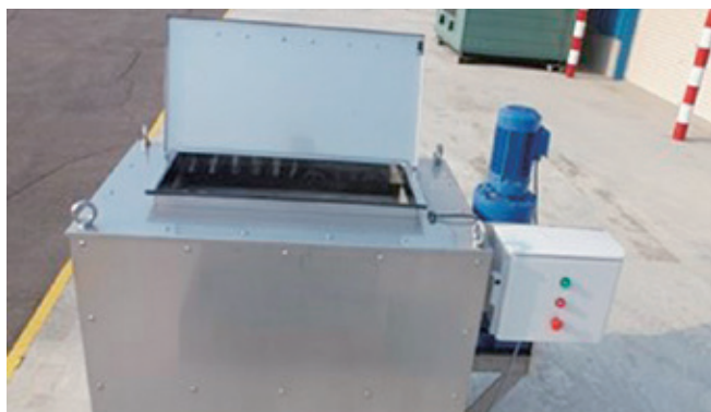
太い骨を処理するため開発された「骨専用破砕機」。
